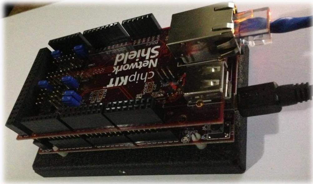
**Figura 6.7.** Concentrador de datos Modbus TCP/IP conectado mediante Ethernet.
