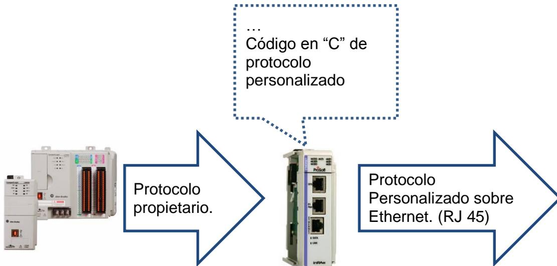
**Figura 5.2.** Esquema general de solución A mediante módulo MVI69-ADMNET de Prosoft Technology.
