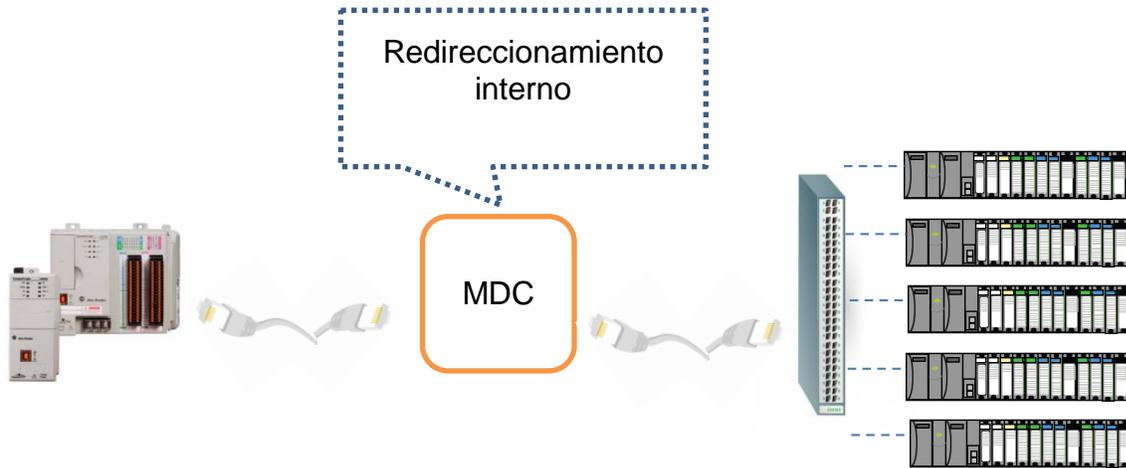
**Figura 5.4.** Esquema general de solución C que interconecta dispositivos Modbus TCP/IP.
