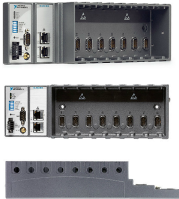
Figura 4.4: Sistema cRIO utilizado para la adquisición de datos de la sonda Langmuir.
