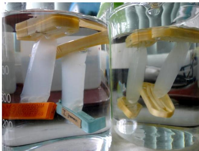
**Figura 19.** Montaje de tubos de diálisis con capacidad de  $2 \text{ mL}\cdot\text{cm}^{-1}$ , utilizados para la purificación de los extractos crudos de soya<sup>13</sup>.
