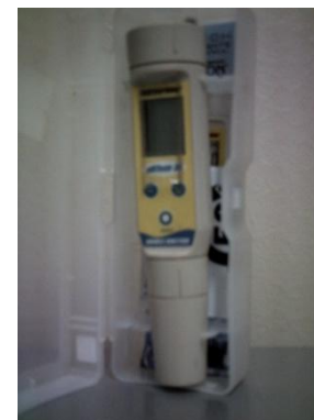
Figura A.7.57. Kit HACH para determinar cloro libre y total. Figura A.7.58. Turbidímetro de columna Kit OXFAM DELAGUA. Figura A.7.59. Medidor de pH OAKTON.
