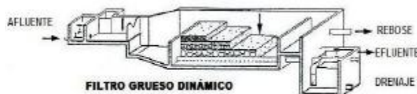
Figura A.1.1. Esquema de un Filtro Grueso Dinámico. (Sánchez, L. et al, 2007)
