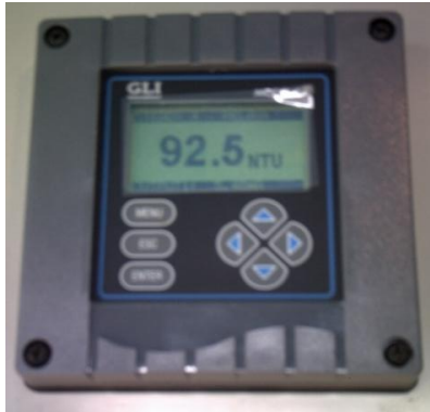
Figuras A.7.26 a A.7.28. Pantalla digital de la lectura de turbiedad; válvula automática de control de alimentación a la planta y control del modo de operación y de las válvulas automáticas.
