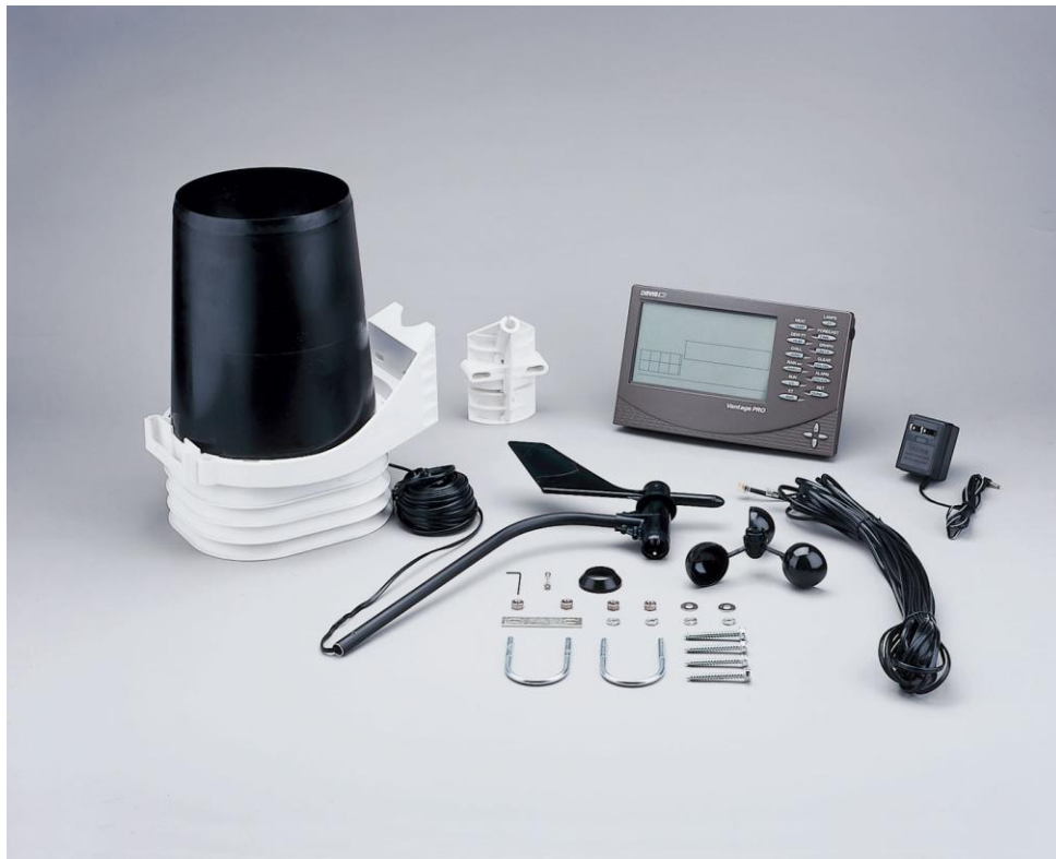
Figura 5 Sistema de recolección de datos; consola Vantage Pro2™ y estación climática.
