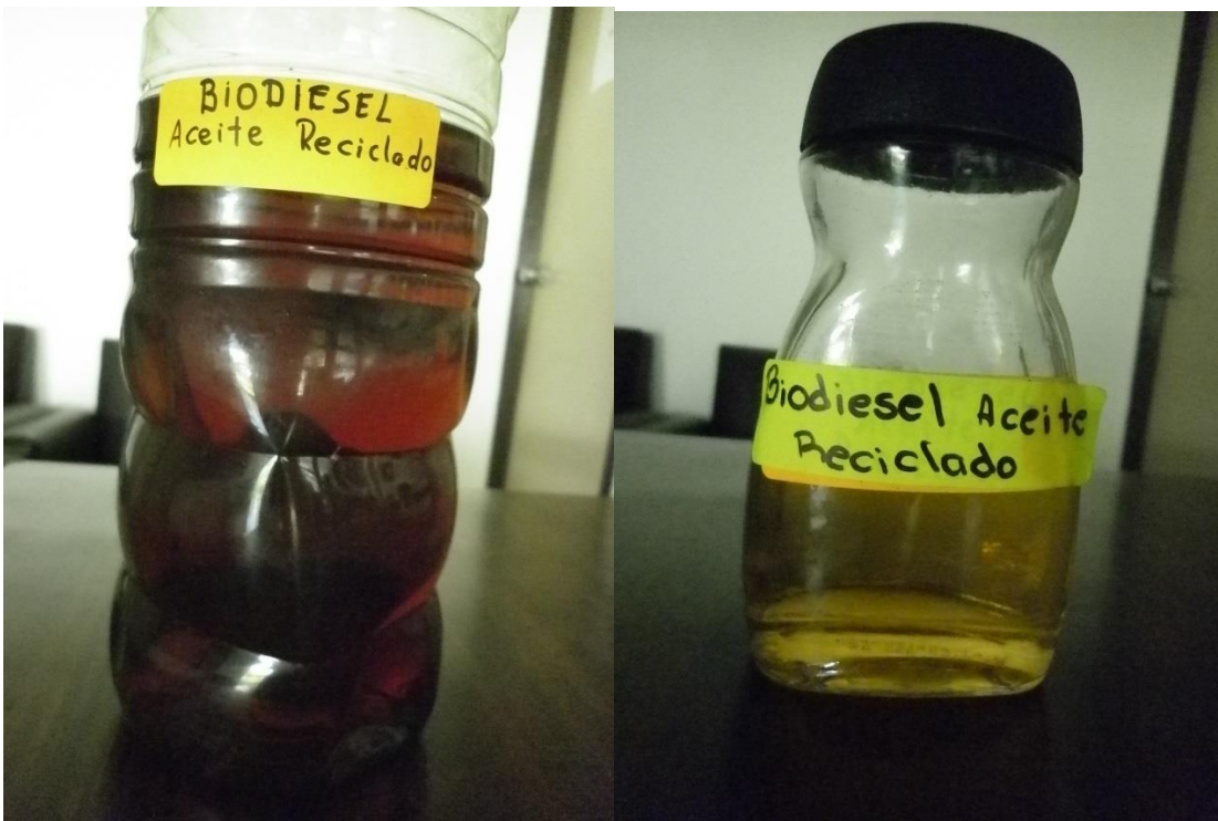
Comparación entre el biodiesel de aceites usados sin filtrar y filtrado
