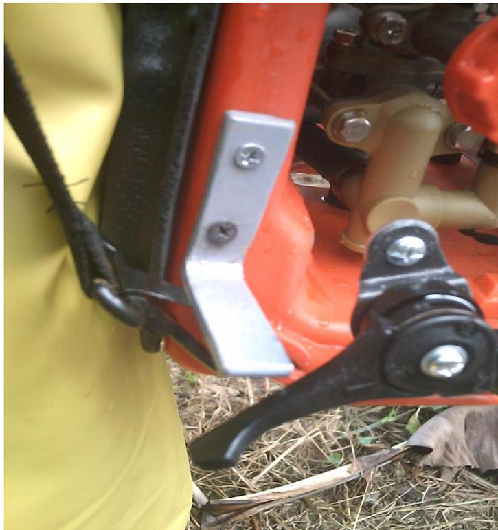
Figura A4. Aseguración de la aceleración de la motobomba.
