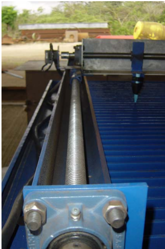
Figura 6.7 Detalle del acople de un motor al eje X de la máquina
