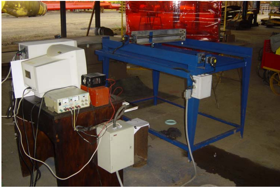
Figura 6.4 Imagen del sistema electrónico acoplado a la mesa construida
