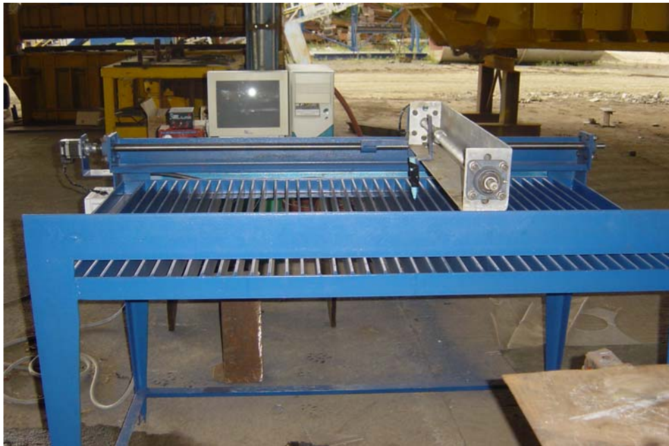
Figura 6.3 Fotografía lateral de la mesa de corte construida
