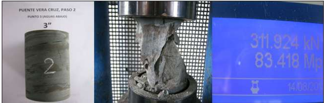
Figura 54. Prueba de resistencia a compresión inconfiada.
