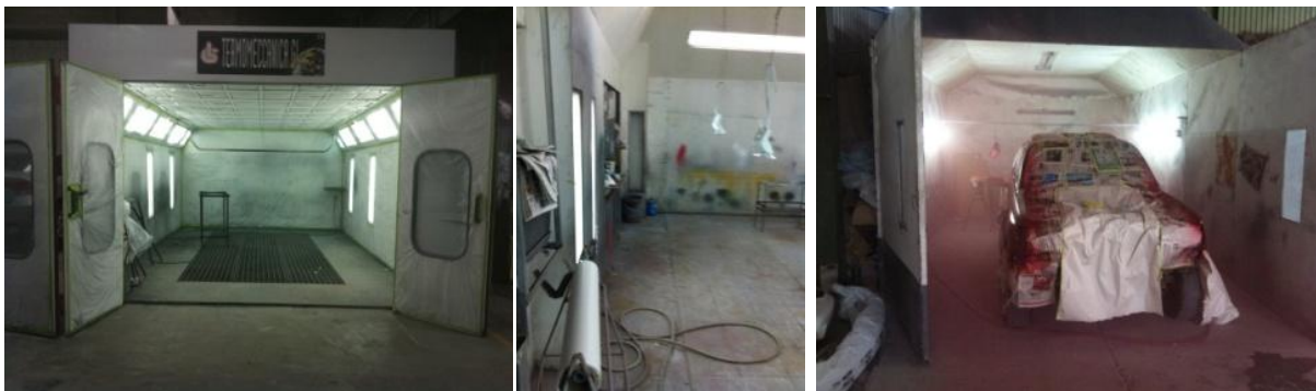
(3a) (3b) (3c) Figura 3. Ejemplos de cabinas utilizadas para pintar automóviles
