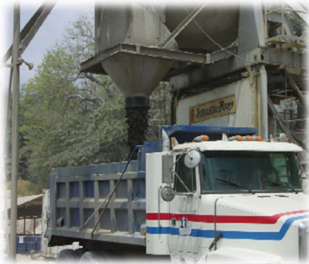
Imagen 3. Descarga de la planta de concreto a los camiones de transporte (a 90°)
