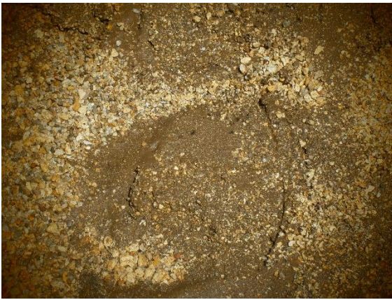
Figura A.4.14 y A.4.15 Arena sucia del filtro y tanque vacío con arena.
