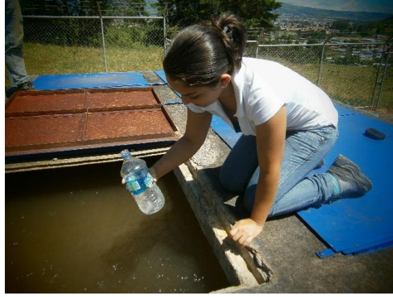
Figura A.4.13 Toma de muestra y agua turbia del filtro.
