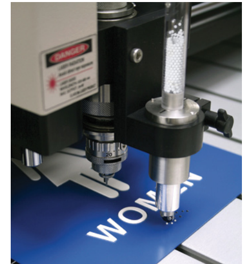
Figura 8. Grabado en alto relieve y código braille en gravotac.
