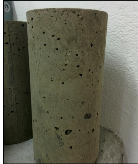
Apéndice T. Cilindro de concreto liviano no estructural.
