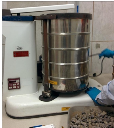
Apéndice J. Agitador mecánico para ensayos de granulometría.
