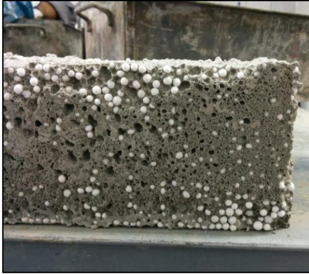
Apéndice R. Lámina hecha utilizando la espuma de concreto
