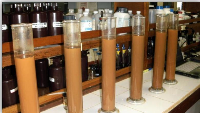
**Figura 17.** Análisis de textura de cada parcela experimental mediante el método de Bouyucos en el laboratorio de suelos de Pindeco, Buenos Aires, Puntarenas, 2013
