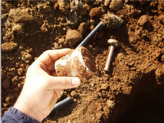
**Figura 14.** Extracción de cilindro con una muestra de suelo para densidad aparente a una profundidad de 25cm antes de siembra en Pindeco Pacífico, Buenos Aires, Puntarenas, 2012.
