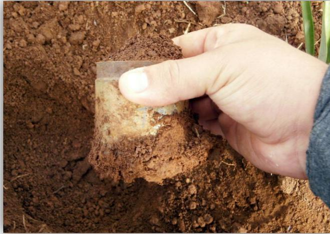
**Figura 15.** Extracción de cilindro con una muestra de suelo para conductividad hidráulica a nivel superficial un mes después de siembra en Pindeco Pacífico, Buenos Aires Puntarenas, 2012.
