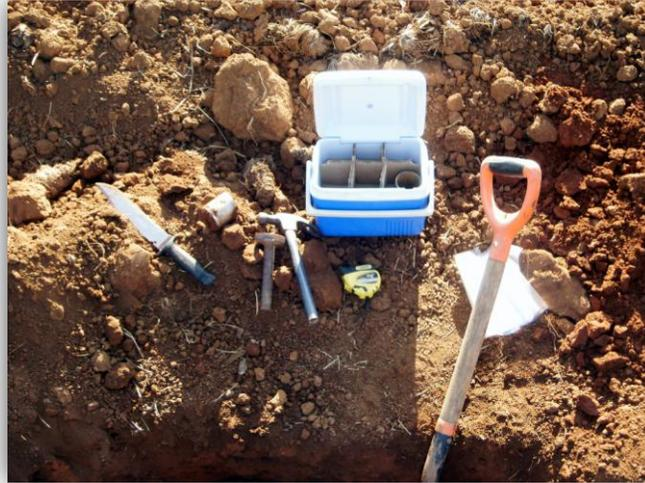
**Figura 13.** Materiales utilizados para la extracción de muestras de suelo para densidad aparente, conductividad hidráulica y análisis químico de suelo.
