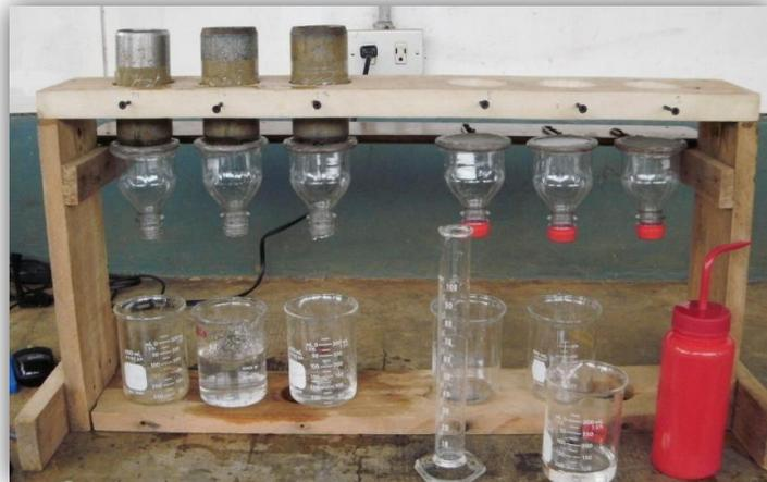
**Figura 16.** Instrumento confeccionado para el trabajo de investigación para realizar pruebas simultaneas de conductividad hidráulica en Pindeco Pacífico, Buenos Aires Puntarenas, 2012.
