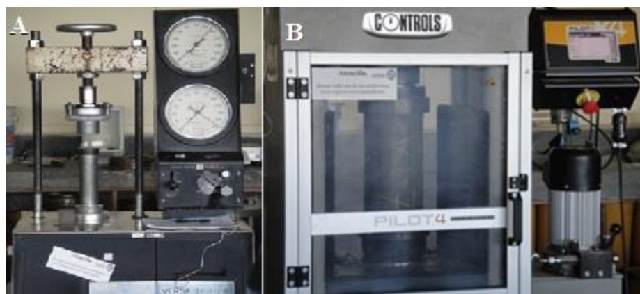
Figura 3.5. Máquinas utilizadas para medir resistencia a la compresión del laboratorio del CIVCO. A. Versa Tester. B. Máquina de Ensayos Controls 3000 kN, modelo 50-C5744.
