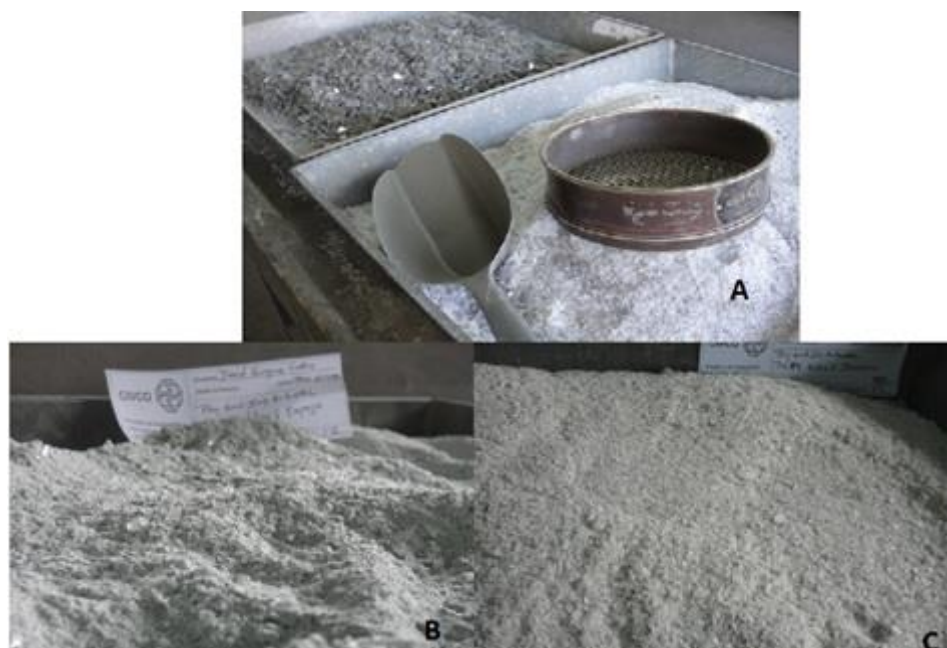
Figura 2.6. Vidrios molidos y tamizados con la malla #4. Figura A es el vidrio reflectivo. Figura B es el vidrio espejo. Figura C es el vidrio incoloro.
