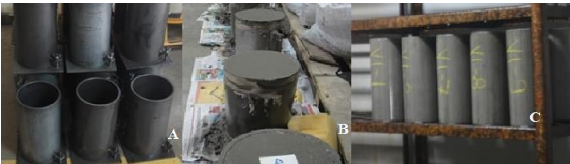
Figura 3.4. A. Moldes utilizados para las mezclas de concreto. B. Concreto recién hecho y moldeado. C. Cilindros de concreto rotulados y colocados en la Cámara Húmeda.
