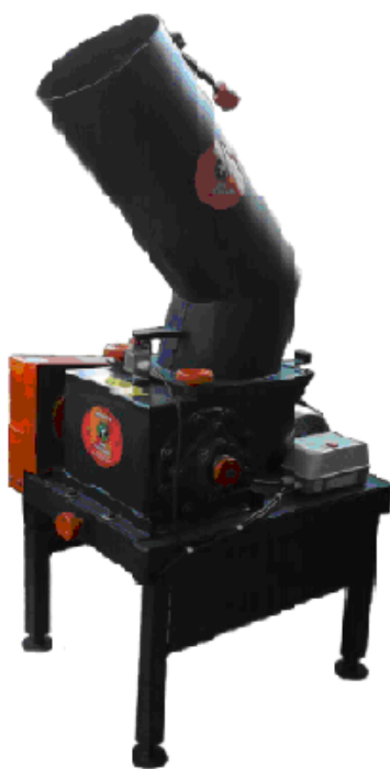
Figura Ax.3.1. Características técnicas del Molino para vidrio de la empresa Maquinaria para Reciclaje.
