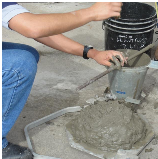
Figura 4.6. Resultado de una de las pruebas de revenimiento por medio del cono de Abrams.
