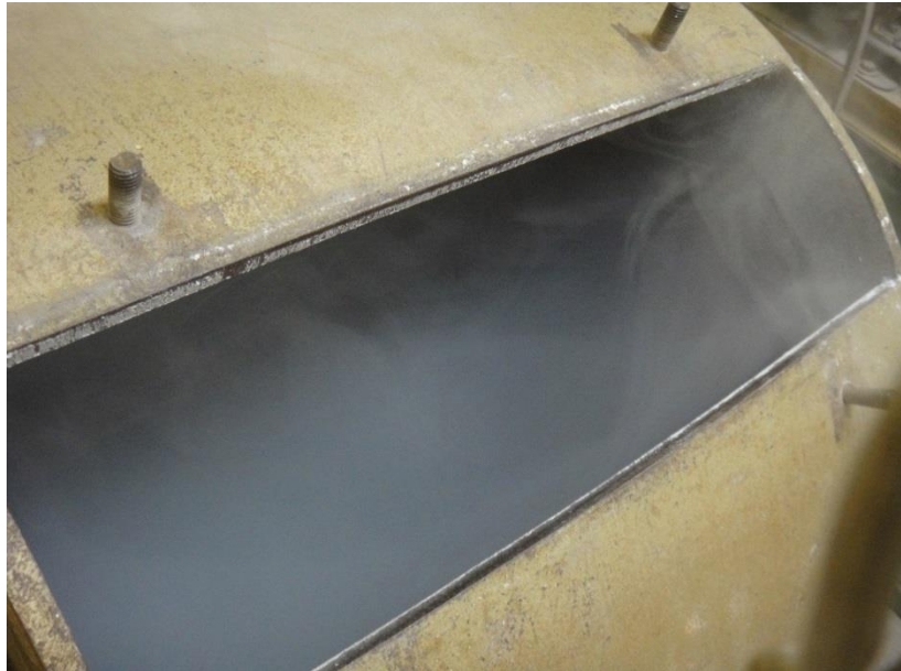
Figura 4.7. Máquina de Abrasión de los Ángeles abierta recién terminado un tiraje de molienda del vidrio.
