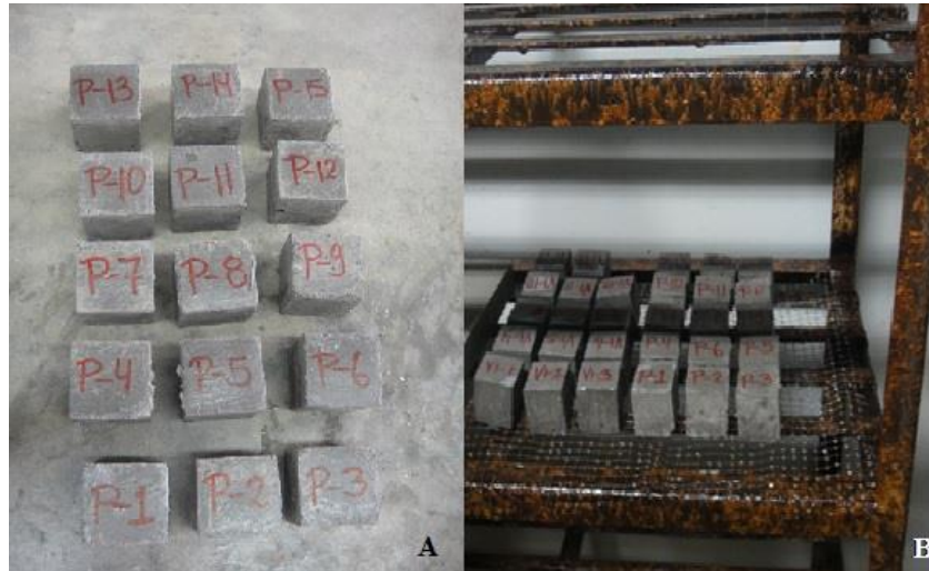
Figura 3.3. Cubos de morteros. A. Rotulación de las muestras. B. Cámara Húmeda donde permanecen los morteros.
