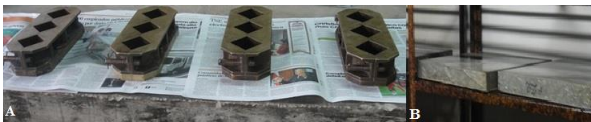
Figura 3.2. A. Moldes utilizados para las muestras de mortero. B. Los moldes de los morteros quedan tapados en la Cámara Húmeda durante las primeras 24 horas.
