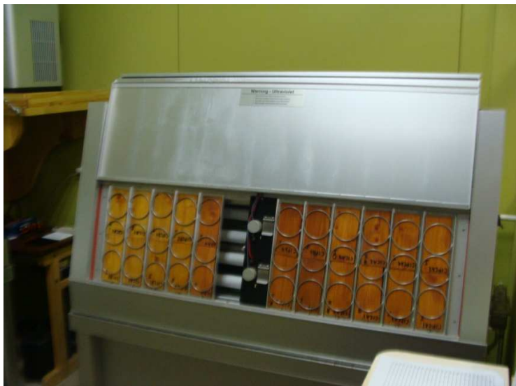
Muestras expuestas en la cámara de envejecimiento acelerado
