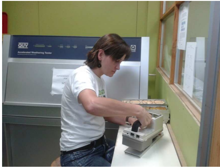
Medición del color de las muestras expuestas en la cámara de envejecimiento acelerado
