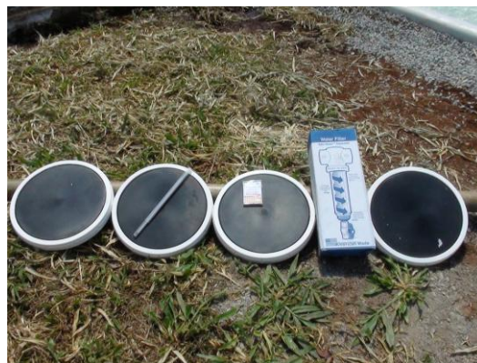
Figura 22. Platos difusores de CO 2 que se instalan en el fondo del estanque, ITCR, 2013.
