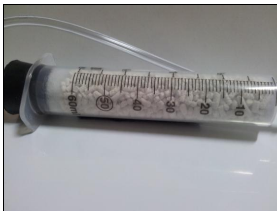
Figura 19. Cal sodada utilizada como base para la calibración del sensor de CO 2
