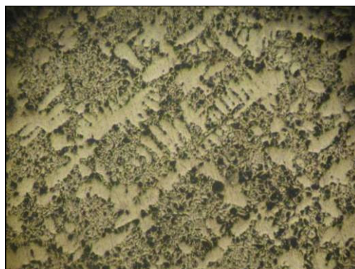
Figura No.44: Metalografía a 100X, sin ataque, ubicación zona de contacto del fondo 38, C-1925; tipo VII, tamaño 8, distribución D.
