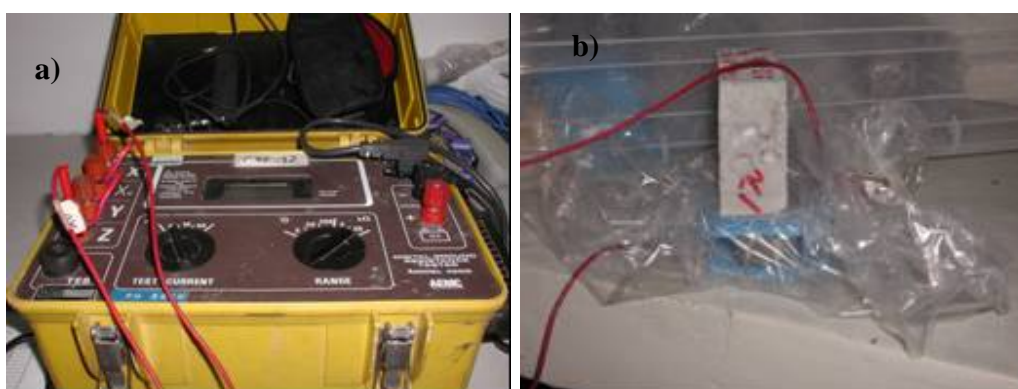
Figura N° 13. a) Resistómetro empleado para hacer las pruebas de resistividad eléctrica y b) Sistema armado: bolsa plástica, placa de acero inoxidable, esponja, probeta de medición, esponja, placa de acero inoxidable, bolsa plástica y contrapeso.
