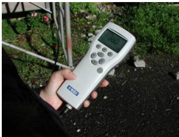
Figura N° 12. Equipo usado en las mediciones de concentración de CO 2 en el ambiente.
