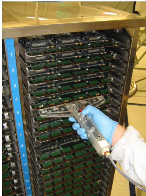
Figura 6.9. Interfaz mecánica haciendo contacto con los terminales de una tarjeta BIB.
