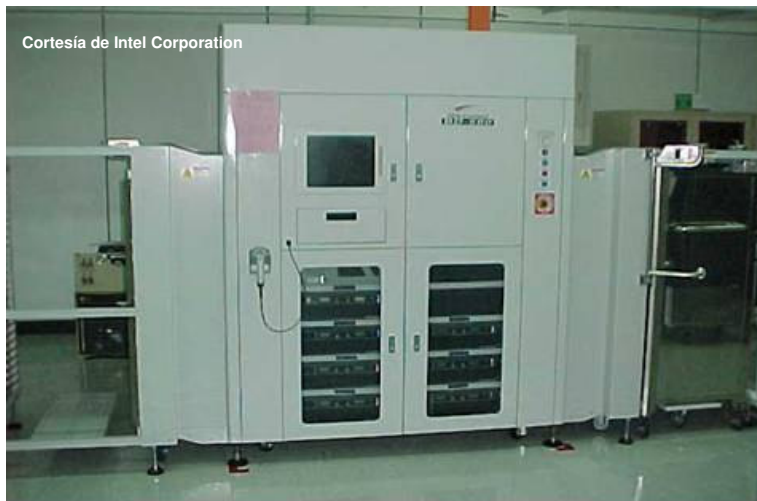
Figura 4.4. Máquina encargada de realizar la prueba de envejecimiento acelerado
