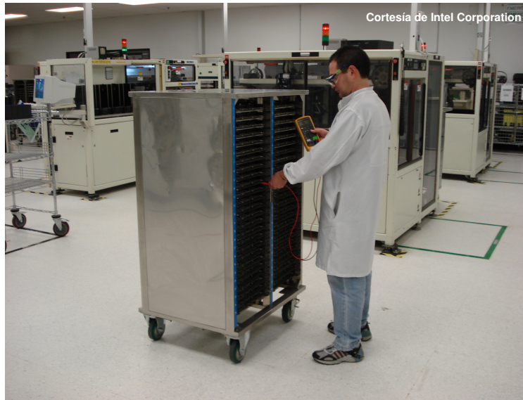
Figura 4.5. Operario realizando la prueba de Resistencia entre Vcc y Tierra.
