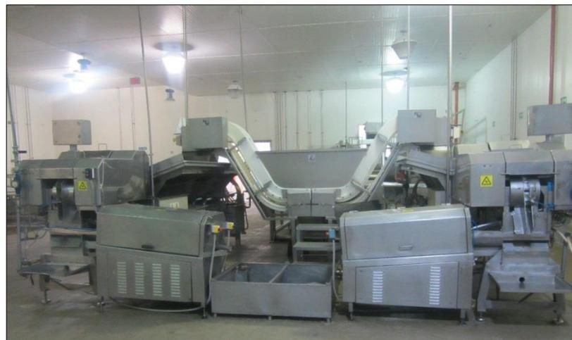
Figura 4.3.9 Cortadoras evisceradoras #1 y #2.
