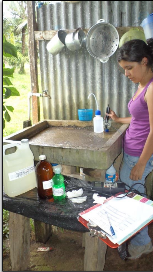
Figura 10 .Medida de oxígeno disuelto de la muestra #7.
