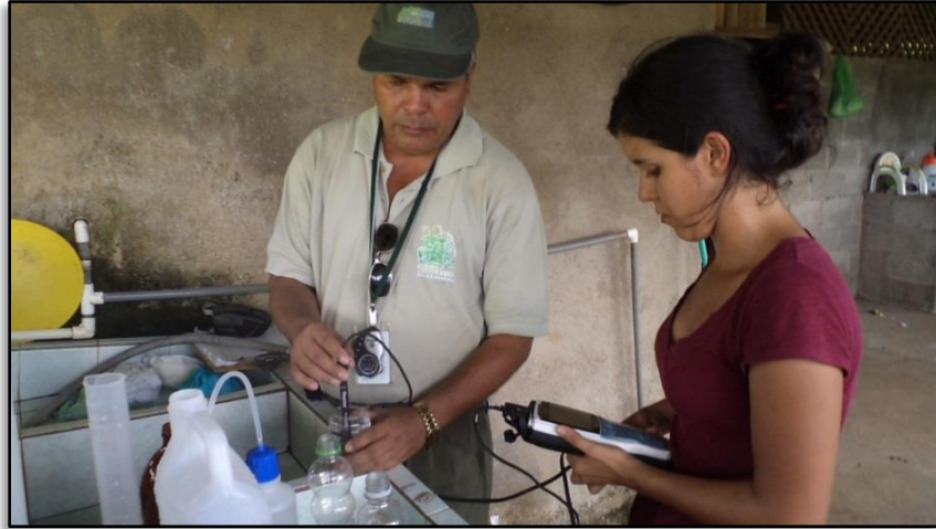
Figura 9.Toma de dato ph y conductividad de la muestra #3.
