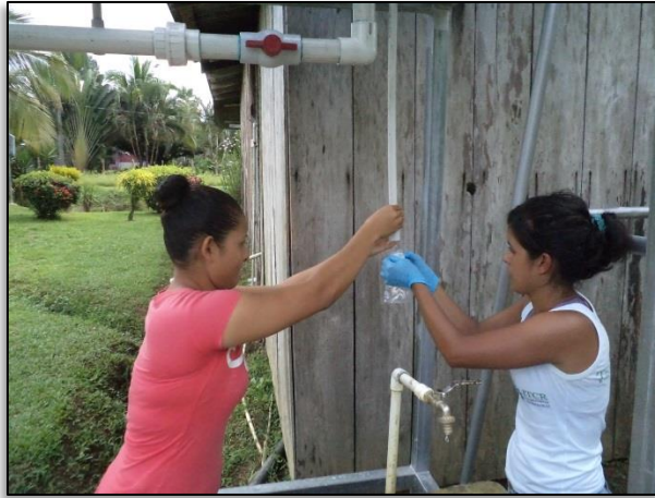
Figura 11. Toma de muestra microbiológica en el tanque# 2.
