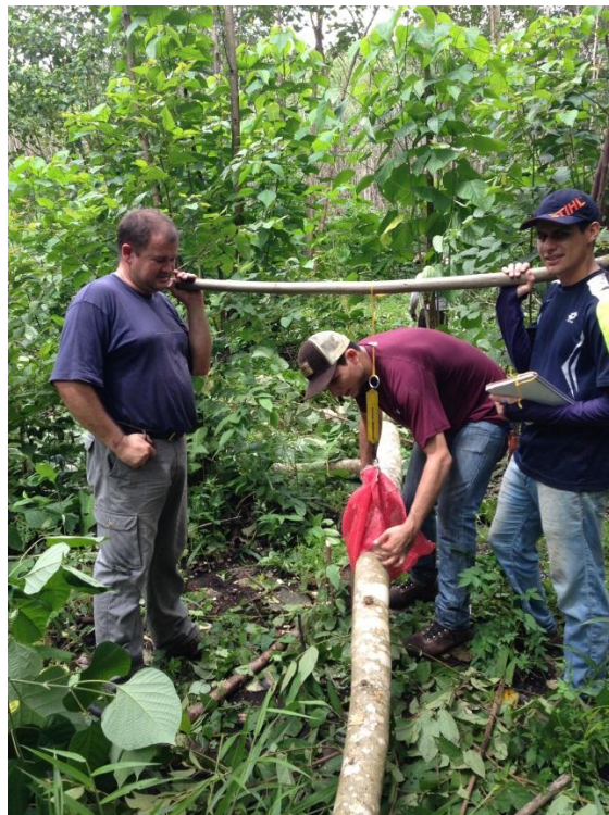
Figura 6. Medición de peso verde de los residuos de árboles R2 en plantaciones de Gmelina arborea (melina) con una balanza colgante.
