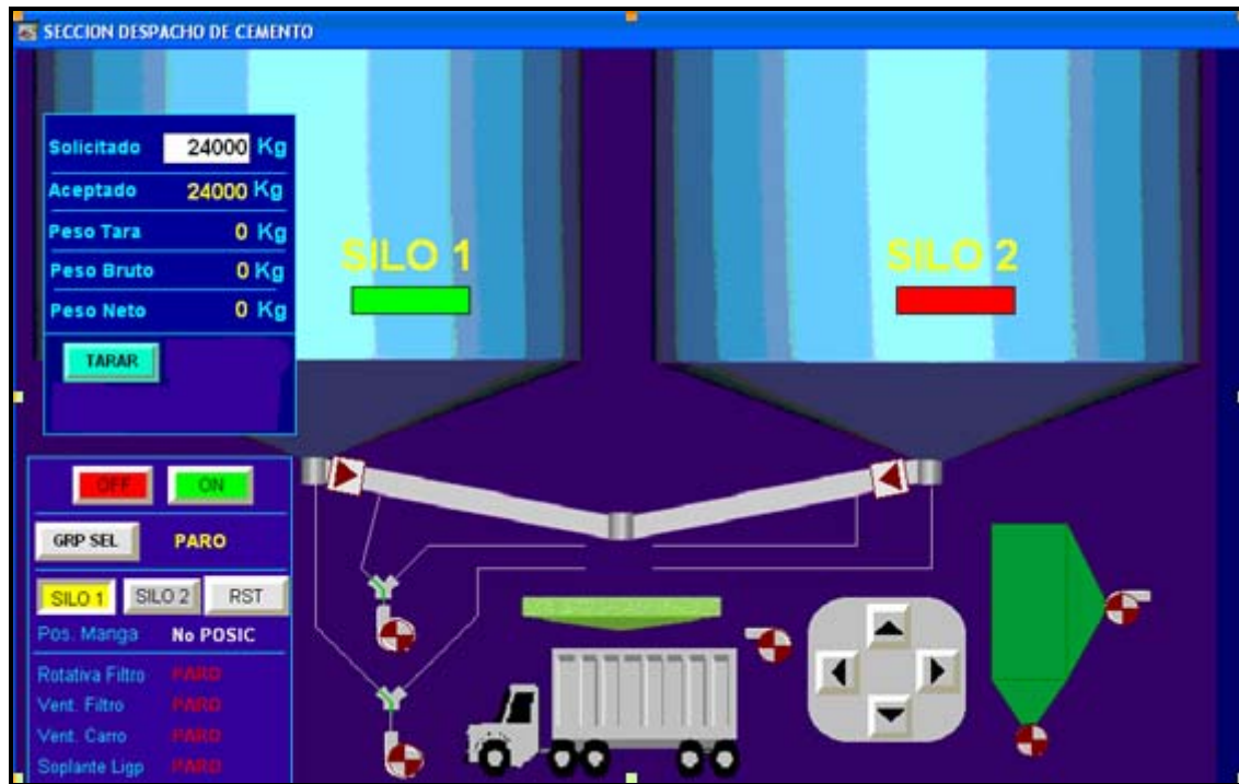
Figura No. 21. Interfaz con el usuario del programa que realiza las entregas de cemento a granel.
