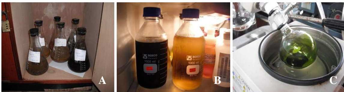
Figura 8. Proceso para la obtención de extractos, (A): Almacenamiento con Hex, ace. y met. (B): Filtrados recolectados y almacenados en refrigeración. (C): Destilación a presión reducida. Tomadas con cámara digital, Santa Clara, San Carlos (López 2010).
