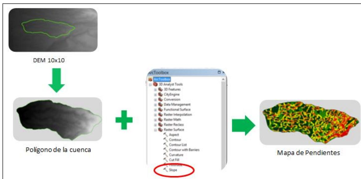
Figura 3 – Determinación del rango de pendientes para la microcuenca del río Jaboncillal por medio de la herramienta slope.
