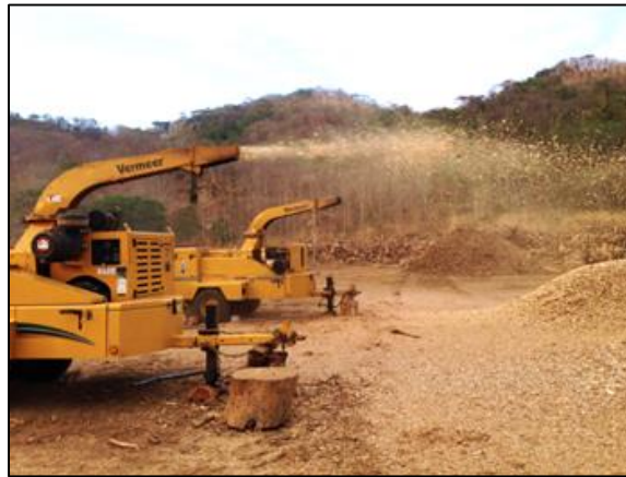
Figura 4. Astilladoras en funcionamiento de la empresa Biomass Costa Rica, Guanacaste. Fuente: (Biomass Costa Rica, 2014)
