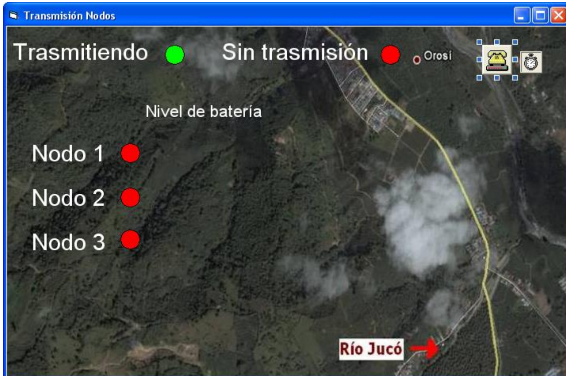
Figura 23. Formulario conexión mostrando la transmisión de los nodos y su respectivo nivel de batería
