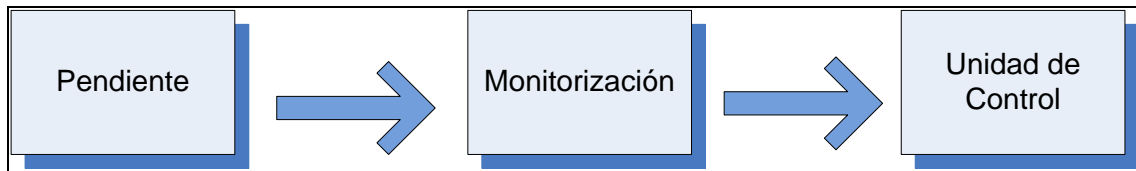
Figura 2. Sistema de alarma contra deslizamientos
