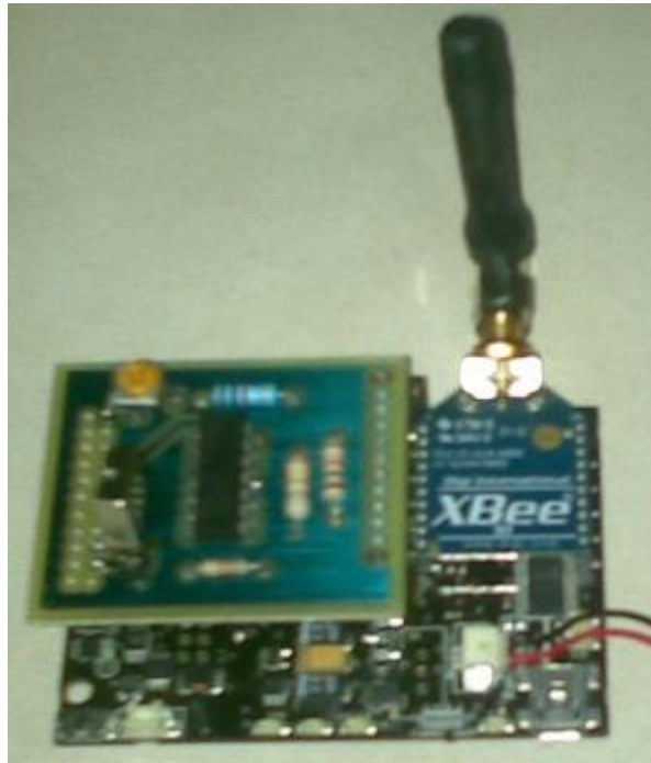
Figura 25. Acondicionador de señal colocado en el waspmote
