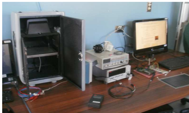
Figura 7: Sistema de caracterización utilizado. En la figura se puede observar la caja de caracterización, el instrumento de fuente y medición (SMU) y la computadora que comanda y recoge los datos del SMU.
