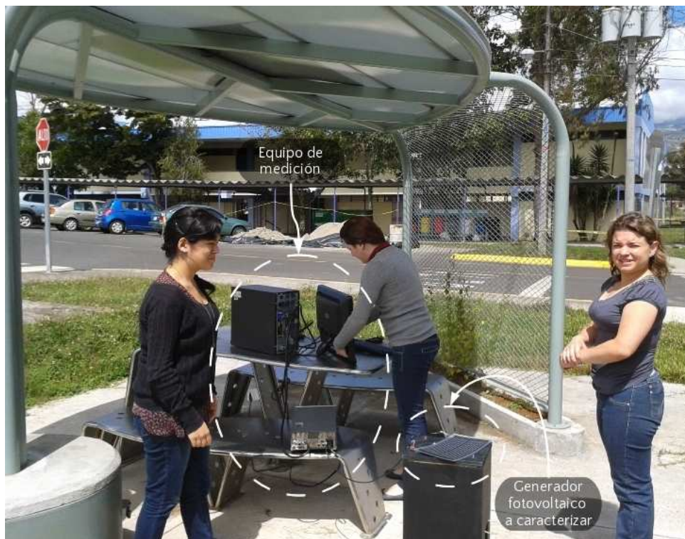
Figura 9: Medición de las características eléctricas en exteriores (con radiación solar). Se aprovechó el Foliage desarrollado en el proyecto “Construcción de una Instalación Fotovoltaica Experimental” para alimentar el equipo de medición.
