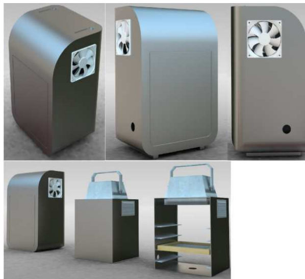
Figura 5: Imagen del modelo en 3D del diseño de la caja de caracterización
