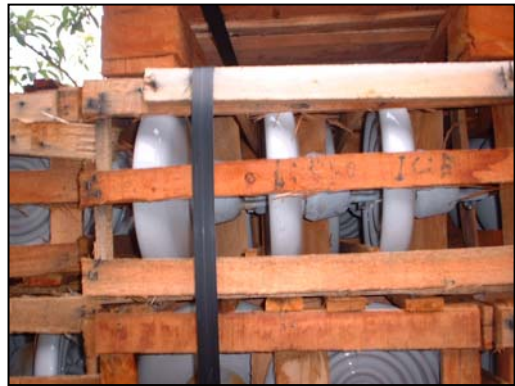
Cadenas de aisladores de disco. Cada cadena esta compuesta de seis discos de \text{Ø} = 255 mm.
