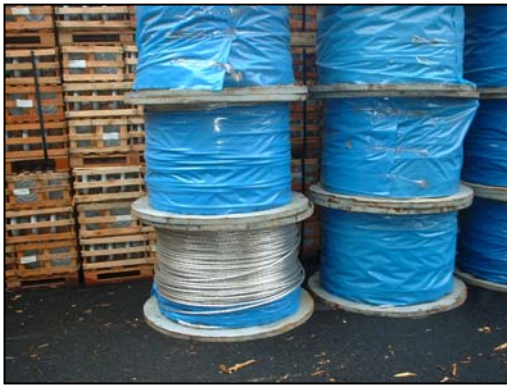
Carruchas de cable desnudo de \text{Ø} = 19 mm para aterrizar los equipos. Cada carrucha es de 2000 mts.
