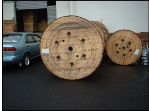
Carruchas de cable simétrico de 150 \Omega . Cada carrucha es de 2000 mts.
