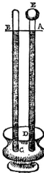
Figura 4.4.2. Barómetro construido por Torricelli en 1644.
