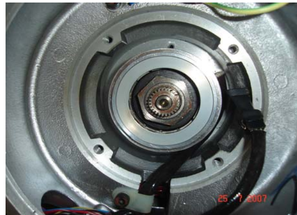
Cortesía de NeoElectronics Figura A.8.6 Colocación de resolver (sobre eje) y el termopar
