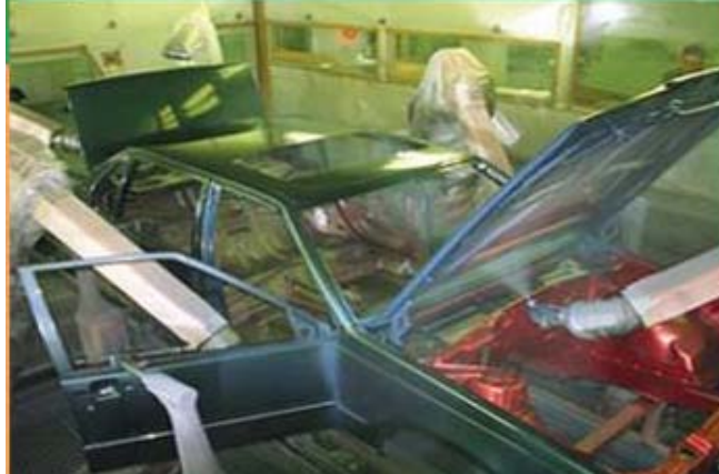
Figura A.3.5 Brazos robóticos utilizados en una celda dedicada a pintar para automóviles
