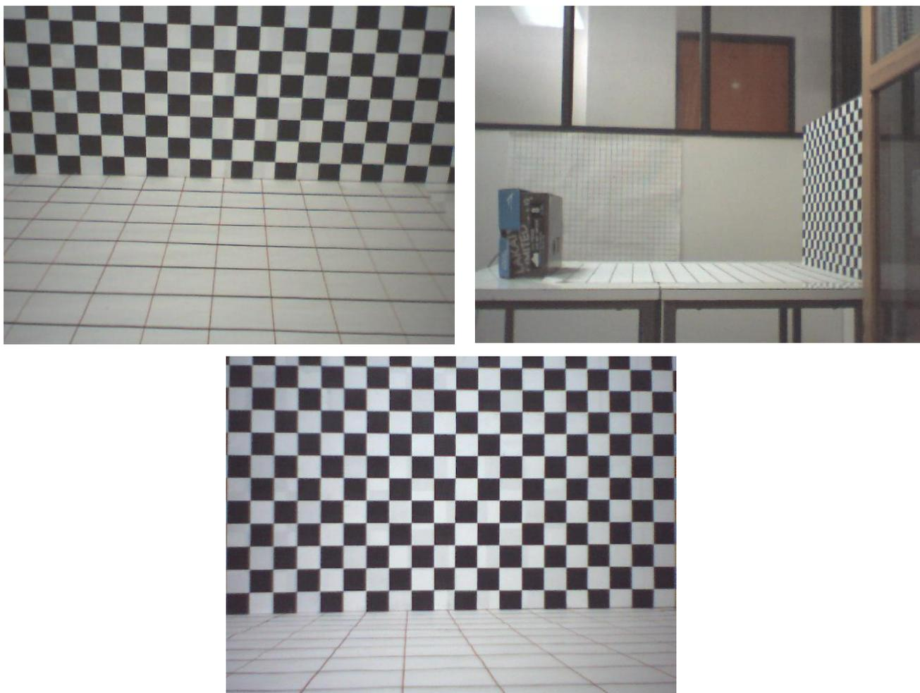
**Figura 23.** Plantilla de calibración utilizada
