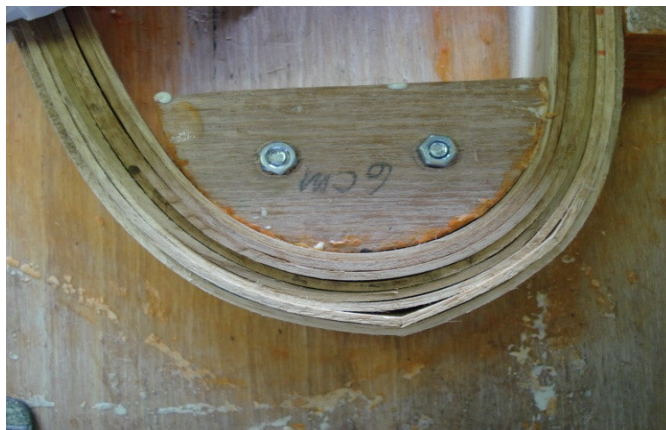
Figura 31. Lámina quebrada al momento del doblado.
