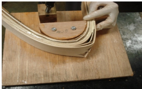
Figura 32. Rompimiento de las láminas en mayor tensión al momento del doblado.
