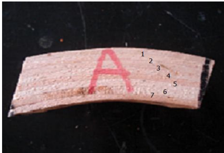
Figura 17. Enumeración para la medición de las delaminaciones
