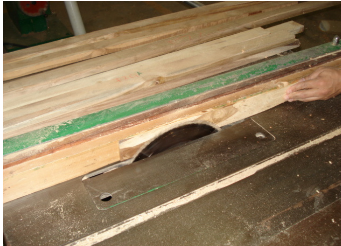
Figura 10. Proceso de preparación del espesor en sierra circular para espesor.
