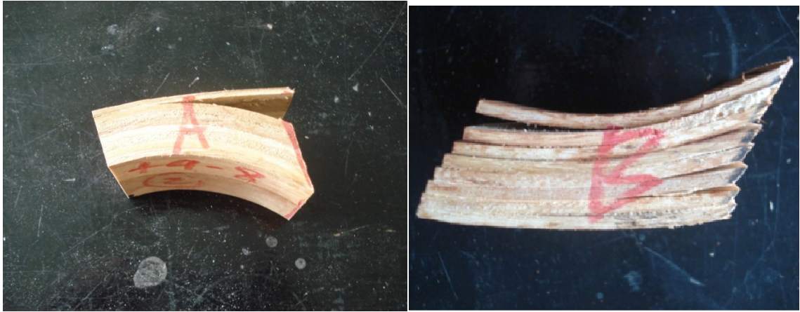
Figura 30. A: Delaminación de unión número 1 en una probeta de teca en radio de 8cm. B: Delaminación total de una probeta de surá de 4 cm.
