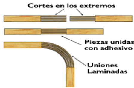
Figura 6. Proceso de uniones laminadas solo en los extremos de piezas sólidas.
