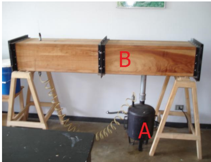
Figura 12. Vaporizador utilizado. A: tanque de vapor. B: Cámara de vaporizado.
