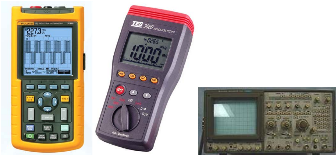
Figura 6.2 Vista de osciloscopio Fluke, medidor de aislamiento TES y osciloscopio Hitachi.
