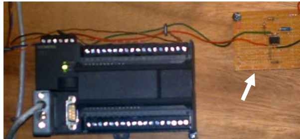
Figura 6.12 Apariencia física de la tarjeta de acondicionador de señales
