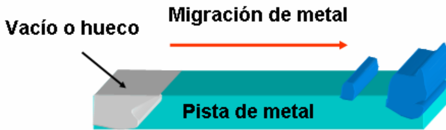
Figura 3.4 Gráfico de efectos de la electromigración
