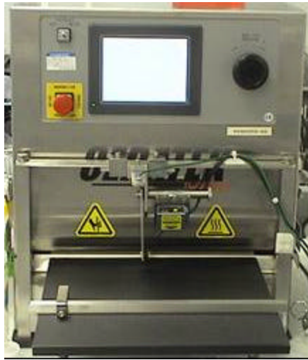
Figura 4. Selladora de bolsas para el proceso productivo del producto GBF.
