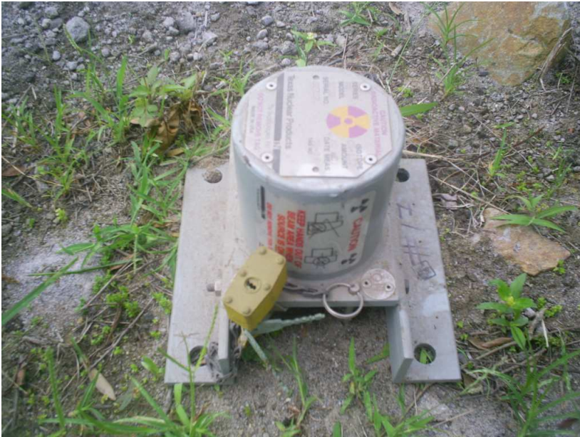
Figura A4. Fotografía del emisor de radiación.
