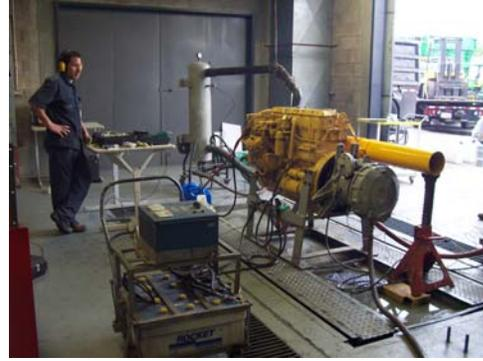
Figura 2. Pruebas de biodiesel en Setiembre del 2005. El Ing. Edwin Montero en la figura izquierda (centro) Jefe del Laboratorio de Lubricantes de Matra nos ayudo en el montaje y ejecucion de las pruebas. El motor montado en la plataforma del dinamometro se muestra en la figura a la derecha.
