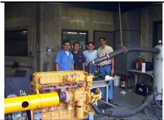
Figure 3. Corrida con biodiesel al 100 % sin producción de humo irritante y con carga en el motor.
