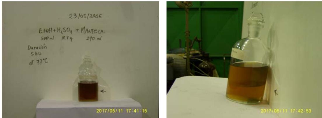
Figura 1. Biodiesel basado en aceite de palma refinado y etanol. Se muestra la separación de fases característica en donde el biodiesel es la fase superior y la glicerina acida la fase inferior.
