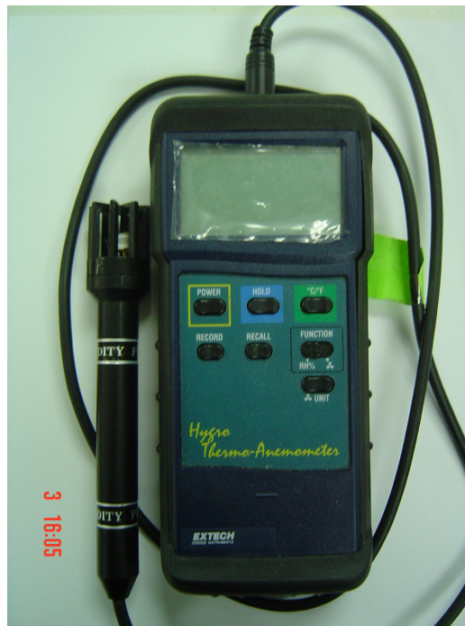
Figura A.3.2.1 Sensor de humedad relativa
