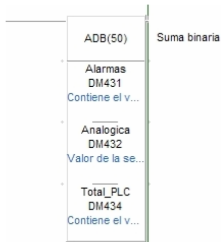
Figura 5.29 Función del PLC que realiza la suma binaria
