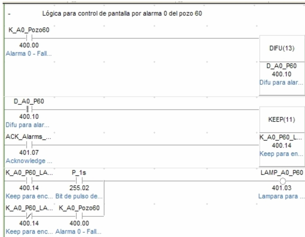
Figura 5.37 Lógica de control para la visualización de las alarmas
