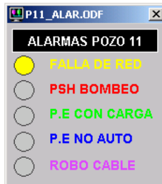
Figura 6.4 Recuadro que muestra las alarmas presentes en el pozo
