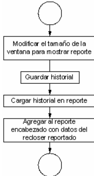
Figura A8.5 Generación de reporte de actividades del recloser
