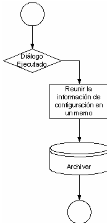
Figura 5.29 Procedimiento para archivar configuración de recloser
