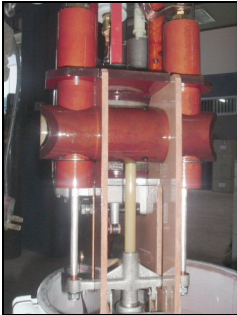
Contacto del recloser tipo E
