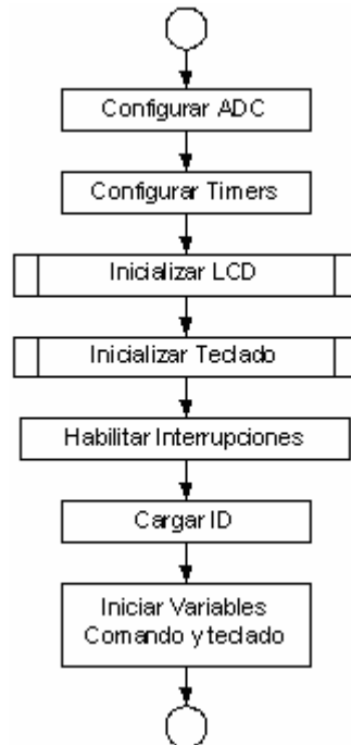
Figura 5.37 Procedimiento de inicialización
