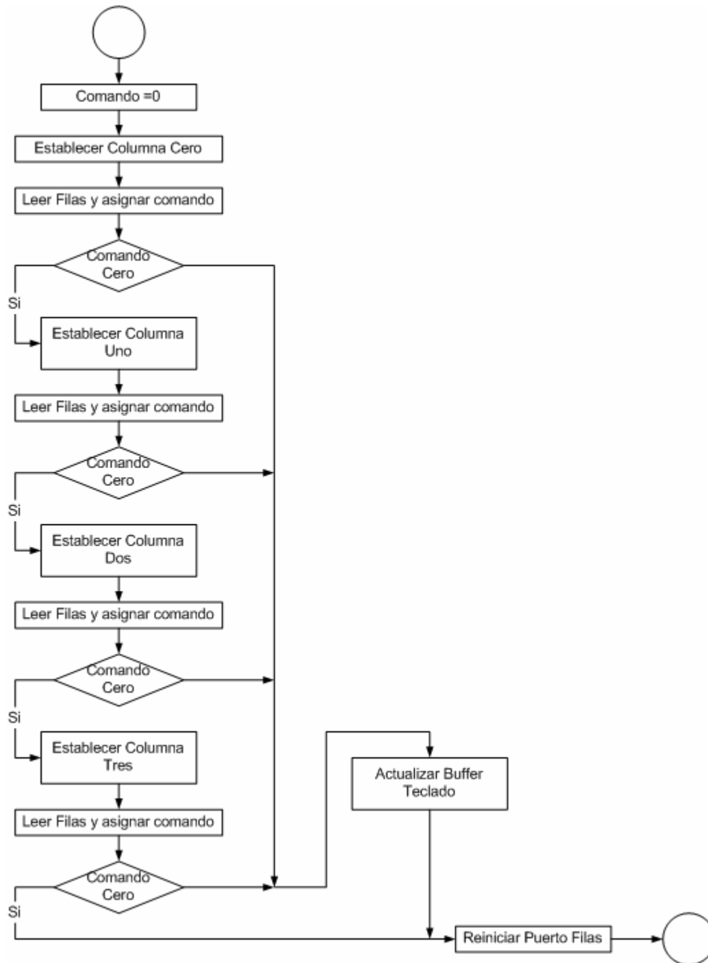
Figura 5.32 Proceso de lectura del teclado
