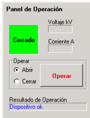
Figura A2.1.1.10 Panel de operación del recloser.
