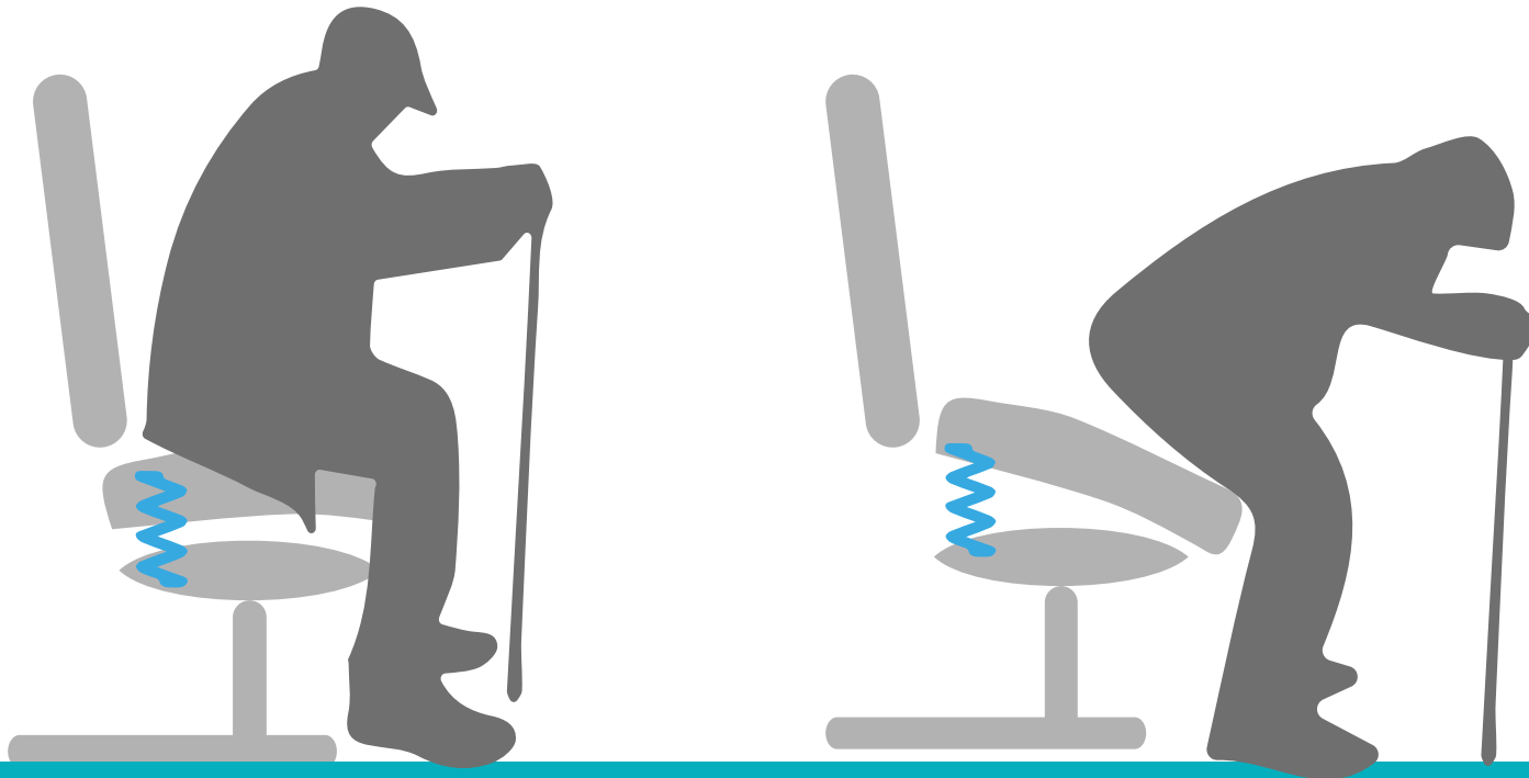
Figura 60_Brief: Elementos de ayuda e impulso_Elaboración propia
