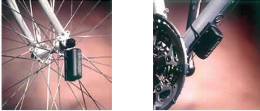
**Figura 2.1** Posibles formas de ubicar el dispositivo transductor en la bicicleta.
