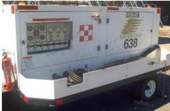
Figura 1.1 Motor y generador de 400 Hz y 115 V RMS
