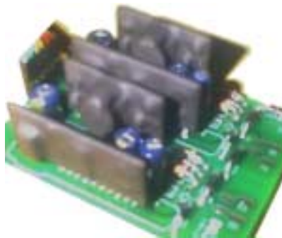
Figura 4.2 Tarjeta gate driver ensamblada para el control de IGBT
