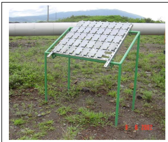
Figura 3.12. Estructuras para montar los paneles de probetas bajo techo y a la intemperie.
