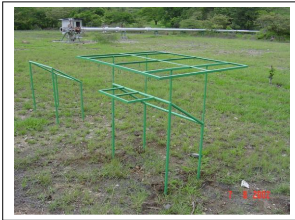
Figura 3.12. Estructuras para montar los paneles de probetas bajo techo y a la intemperie.
