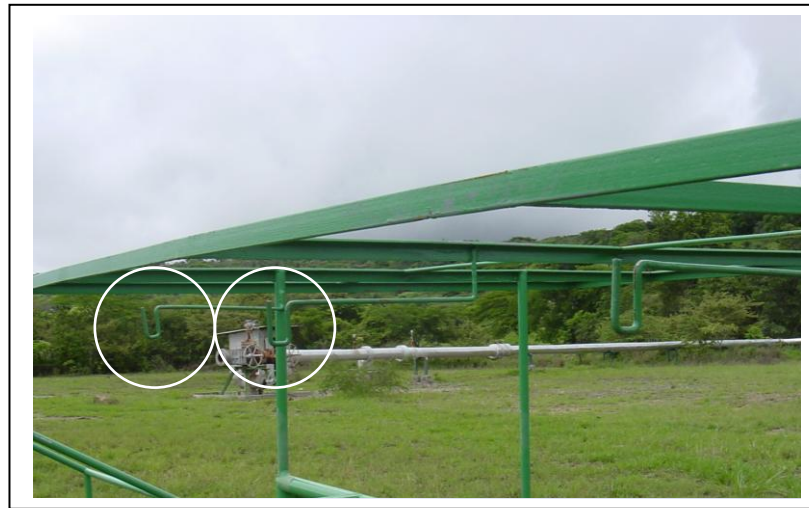
Figura 4.3. Percha para colgar los porta probetas para captar \text{SO}_2
