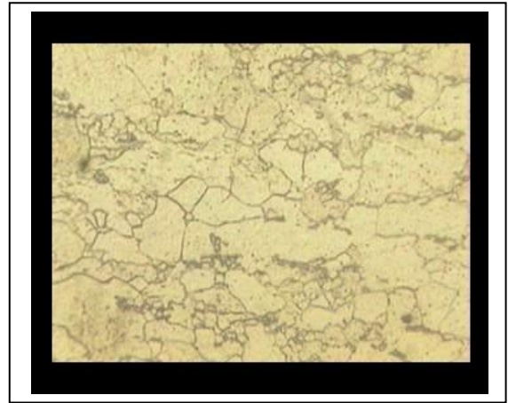
Figura 3. 8. Metalografía lámina 8. Microestructura de ferrita y perlita., Característica del acero estructural. Ataque: Nital 3%. Aumento 400x
