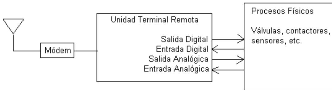
Figura A1.3 Diagrama de bloques que presenta un ejemplo del modo de aplicación de una unidad terminal remota.
