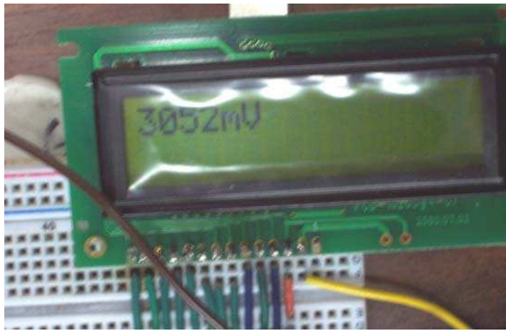
Figura 6.12 Despliegue en pantalla de una tensión medida con el voltímetro
