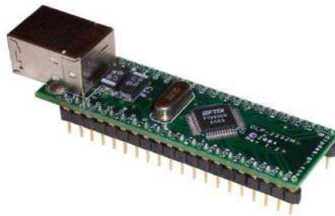
Figura 6.2 Dispositivo para prototipado DLP2232M
