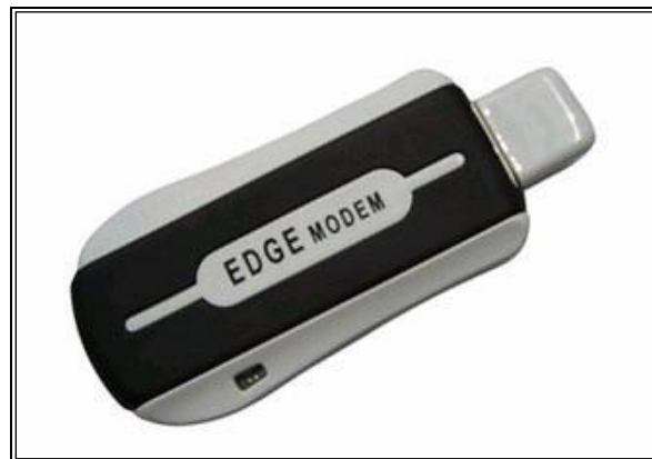
Figura 3. 4 USB EDGE Módem utilizado como equipo de transmisión de información en la red CRTECMOTE y hacia redes externas.
